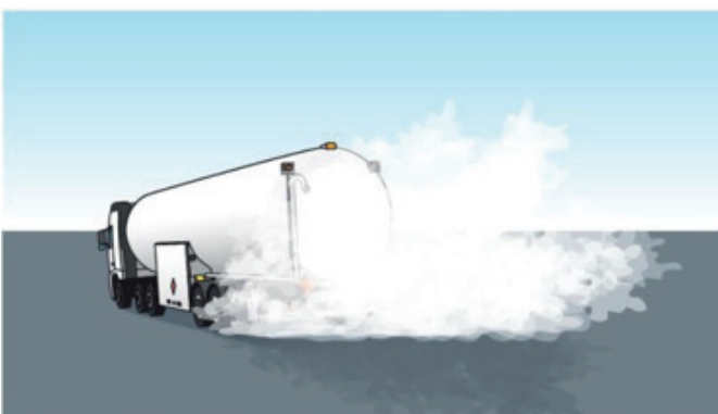
Flytende metan på ikke-nedkjølt underlag ca. 200 m 3 /h/m 2
