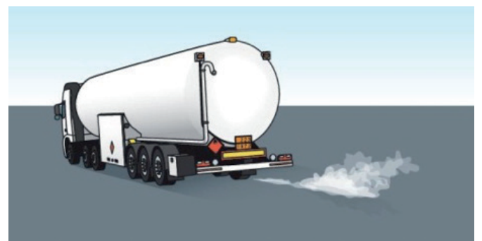
Flytende metan på nedkjølt underlag ca. 20 m 3 /h/m 2
